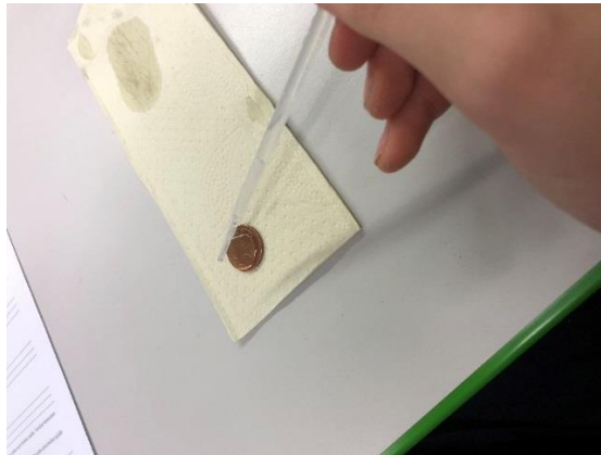
Kolikkotesti havainnollistaa veden pintajännityksen voimakkuutta.
